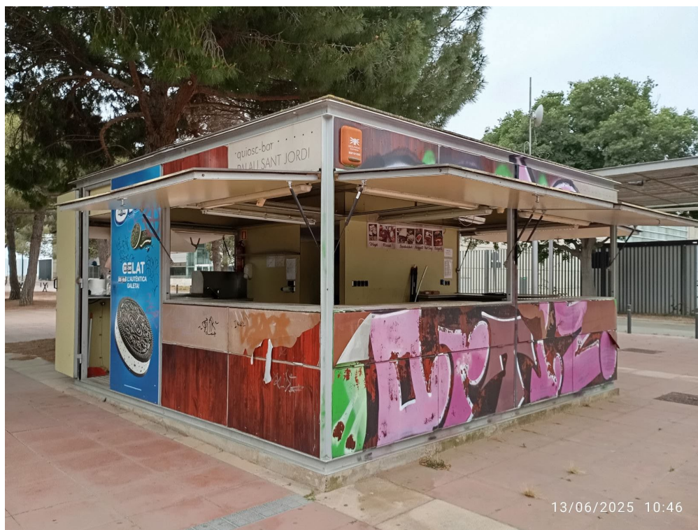
Imatge 9 Retirar vinils exteriors, netejar pintades o pintar i aplicar pintura antigrafitis.
